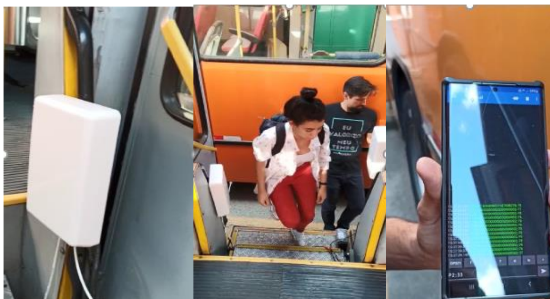
Figura 7: Teste realizado pela URBS: Utilizando o veículo Padron, onde foram posicionadas as antenas (em branco) e o leitor no canto direito ao passar pela porta, subindo ou descendo os degraus do ônibus, uma outra pessoa fora veículo aferia os sinais captados pelo leitor no visor de um smartphone.
